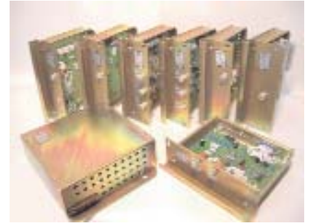
Рис.6 Электронные блоки БУЗ, РНГ, БРНГ, БУО, БРЧ, БТЗ, БЗ, изг. 2007 г.
