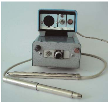
Рис. 5. Устройство для контроля горения в цилиндрах дизеля.
