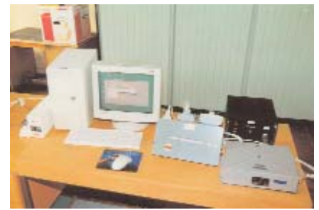
Рис. 12 Автоматизированный стенд тестирования и диагностирования электронных блоков локомотива.
