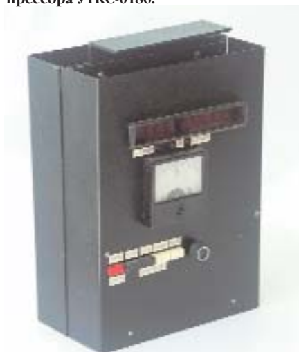
Рис. 11. Устройство для защиты турбокомпрессора от разноса и помпажа.
