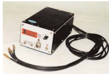
Рис. 8. Устройство измерения тока, напряжения и мощности.
