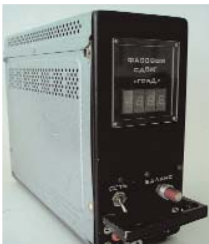
Рис. 4. Электронное устройство для определения фазовых характеристик рабочего процесса.
