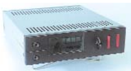
Рис. 3. Устройство для контроля внутрицилиндровых параметров.
