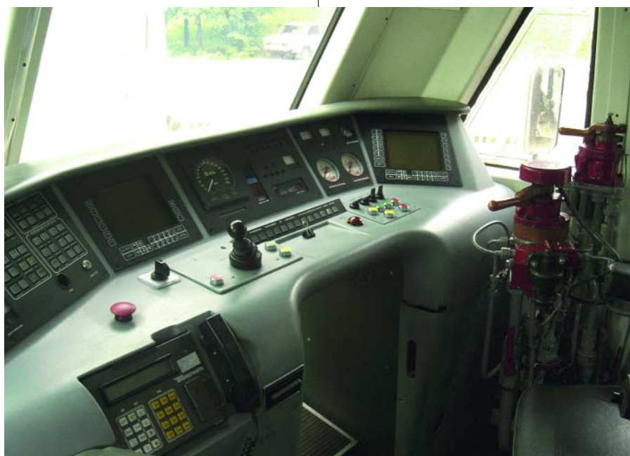
Пульт управления машиниста УНИКАМ. Все органы управления располагаются в пределах рабочего поля машиниста
