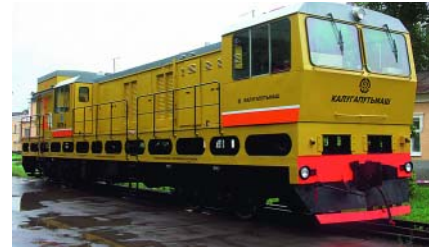
Путевая рельсоварочная машина ПРСМ-6
