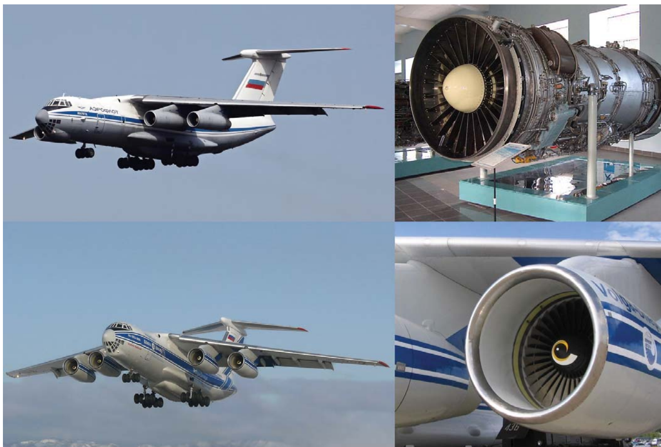
Рис. 3. Самолет Ил-76ТД с двигателями Д-30КП-2 (вверху) и Ил-76ТД-90 с двигателями ПС-90А-76 (внизу)
