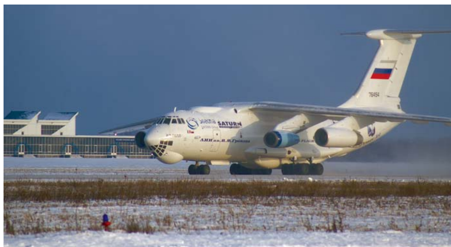
ИЛ-76/Л1 на взлете с двигателем SAM 146 для самолета SSJ 100
